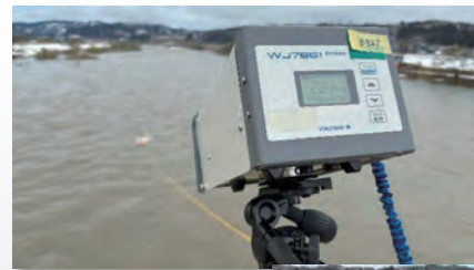
可搬型電波流速計による観測
